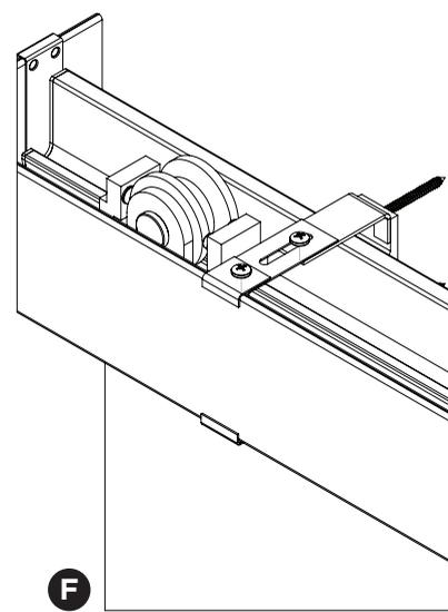
**D)** Déposez le bordure dans le support (B).
