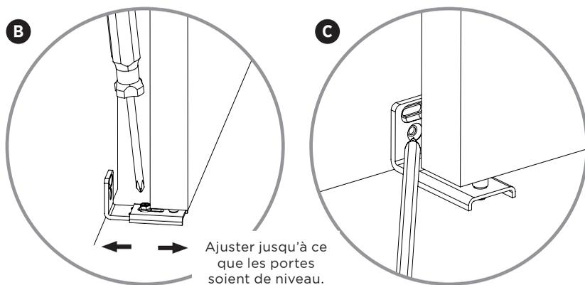
**B)** Utilisez un niveau pour vérifier que la porte est à niveau. Sinon, déplacez légèrement la porte du mur pour accéder à la vis de la plaque et desserrez cette dernière. Repositionnez ensuite la plaque inférieure jusqu'à ce que la porte soit de niveau, puis resserrez la vis.
