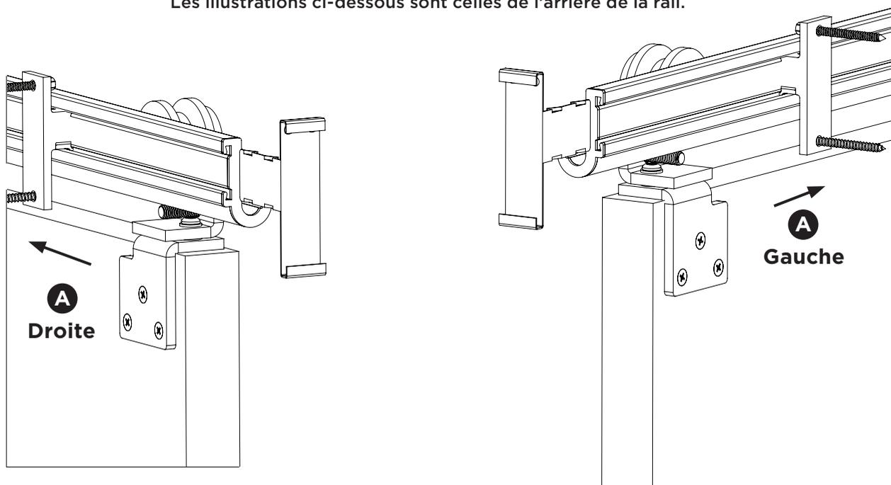
**A)** Fixez les supports de bordure latéraux de l'interface client aux extrémités de canal de le rail, comme indiqué.
