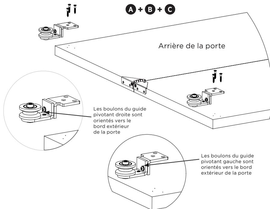
**A)** Laissez la porte en place, avec le bord dépassant l'extrémité de la table d'environ 20 à 25 cm. Positionnez le guide pivotant gauche comme indiqué, la roue vers l'arrière de la porte et le boulon pivotant vers le bord gauche des panneaux assemblés.
