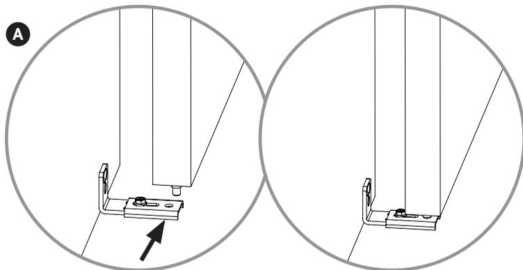
**A)** En maintenant les portes en position fermée, appuyez sur le pivot inférieur et faites glisser le support de pivot inférieur sous le pivot inférieur, de façon à ce que le trou du pivot inférieur soit aligné avec la tige du pivot et que la bride verticale soit affleurante au mur ou à la boiserie.
