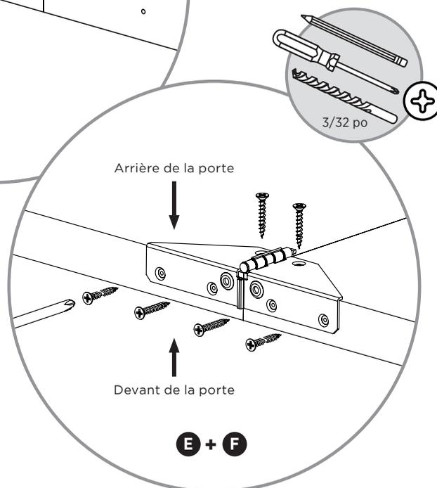
**A)** Déposez les (2) panneaux de portes sur une surface protégée, le devant de chaque panneau vers le bas, et placez-les de façon à ce que les bords centraux se touchent.
