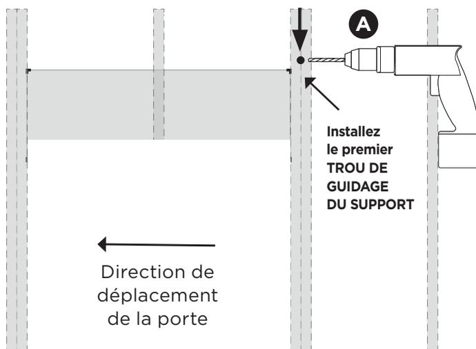
**A)** Utilisez une mèche de 1/8 po pour percer un trou de guidage sur la marque que vous avez faite sur le mur à **étape 8**. Assurez-vous que le support est de niveau avant d'insérer la vis de fixation.
