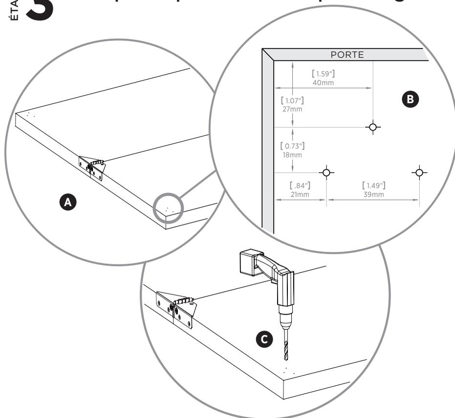
**A)** Retournez la porte sur la surface protégée en plaçant la face avant des panneaux vers le haut. Assurez-vous que les bords supérieurs des panneaux fixés par la charnière à ressort dépassent l'extrémité de la table d'environ 20 à 25 cm.
